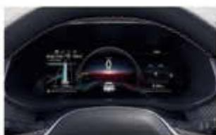
**DAS DIGITALE KONTROLL-INSTRUMENT** im 10-Zoll (25,4-Zentimeter)-Format lässt sich in Farbe und Darstellung der TFT-Anzeigen individuell konfigurieren. Ins Tachodisplay integriert ist auch die Navigationskarte mit allen wichtigen Hinweisen.
